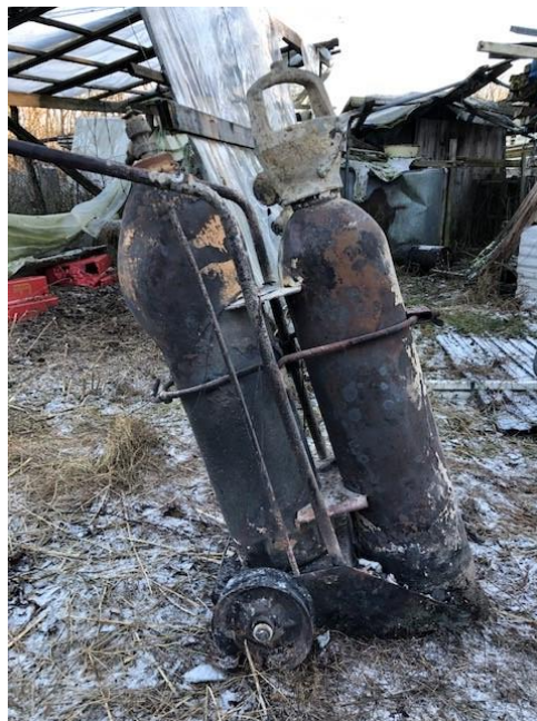
Bild 14 Värmepåverkade gasflaskor Hultavägen 2021. Foto: RSG
