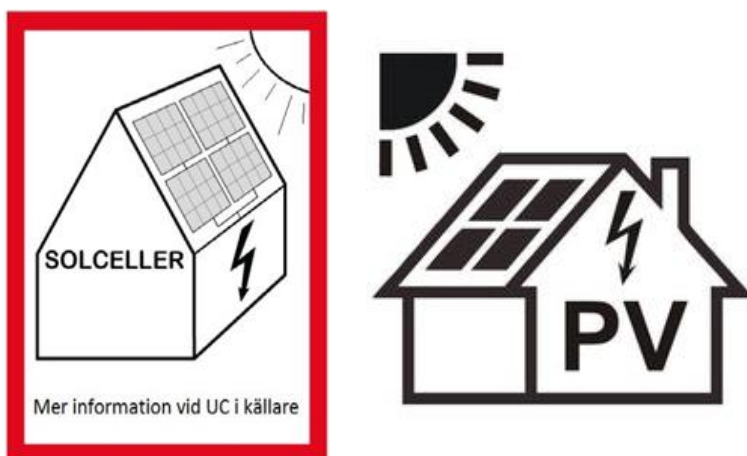
Figur 1. Exempel på skyltning av solcellsanläggning (SEK handbok 457)
