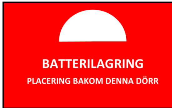
Figur 4. Exempel på skyltning av batterilagring (RSG)
