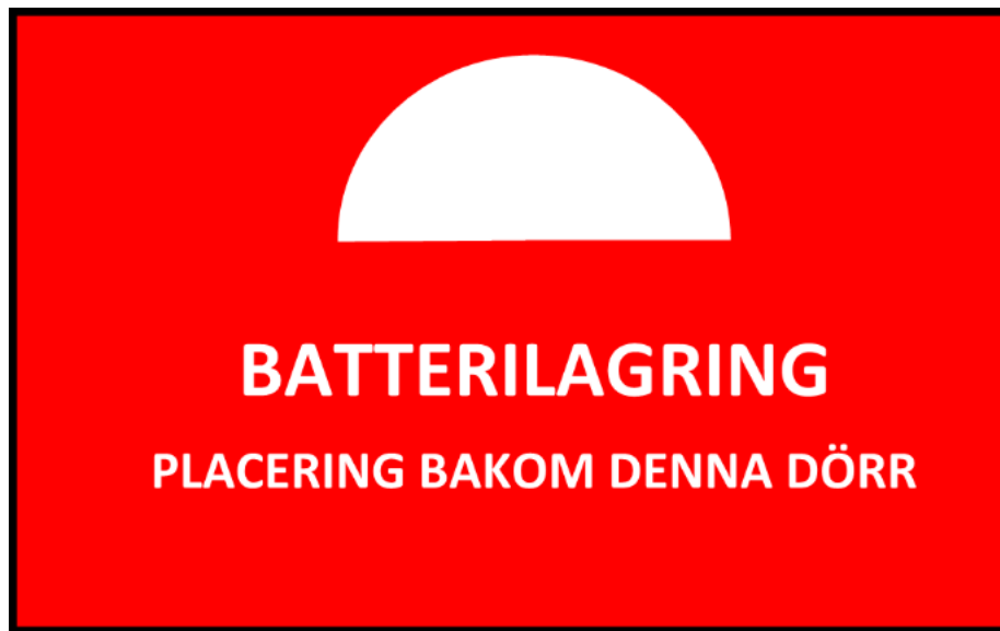
Figur 4. Exempel på skyltning av batterilagring (RSG)
