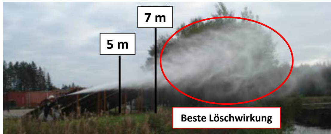
Abb. aus MSB-Bericht: Einsatz des Schneidlöschkonzeptes
