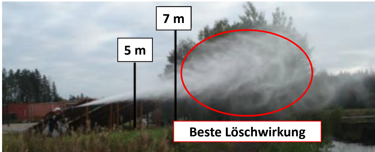
Abb. aus MSB-Bericht: Einsatz des Schneidlöschkonzeptes
